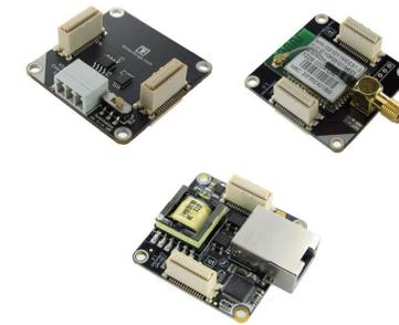
**Master Extensions** sind 4 × 4 cm Platinen die genutzt werden können um die Kommunikationsschnittstellen eines Master Bricks zu erweitern. Mittels Extensions können Stapel per RS485 vernetzt werden oder per Ethernet oder WLAN (802.11b/g/n) gesteuert werden.
